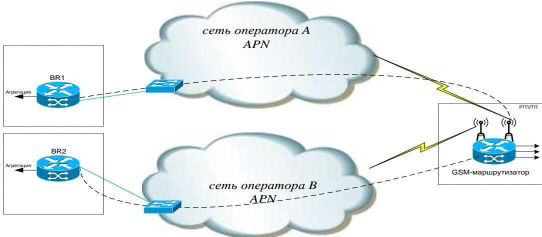
Рисунок 8. Участок беспроводной сети по APN
