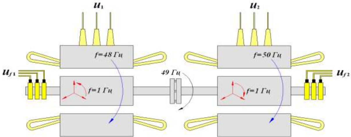
Рисунок 2. Асинхронизированный электромеханический преобразователь
