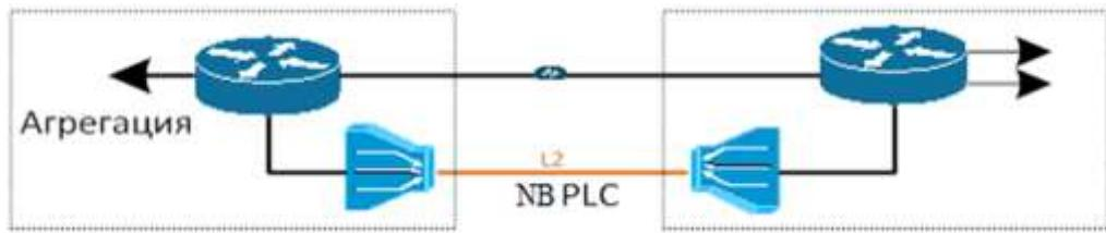
Рисунок 9. Участок сети с использованием PLC
