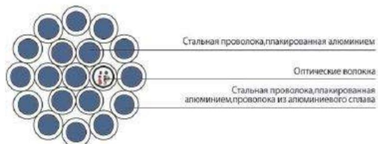
Рисунок 11. Пример оптического кабеля, встроенного в фазный провод
