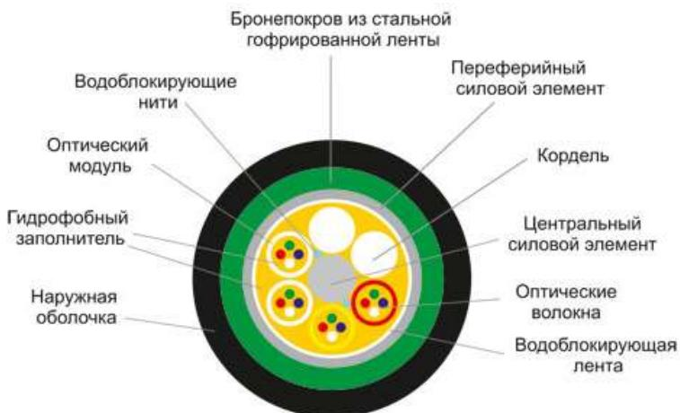
Рисунок 12. Пример конструкции ВОК для прокладки в зданиях
